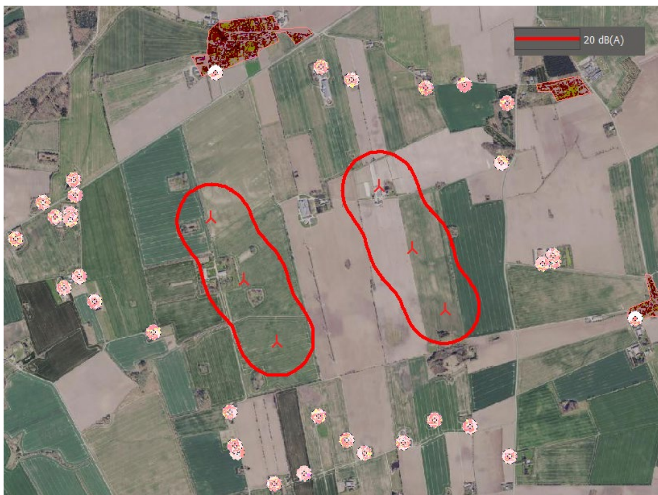
Figur 5-4 Vindmøllernes støjdbredelse for lavfrekvent støj ved en vindhastighed på 8 m/s. Beregningspunkter (nærmeste naboer) for støjdbredelsen er vist ved markering (stjerne).
