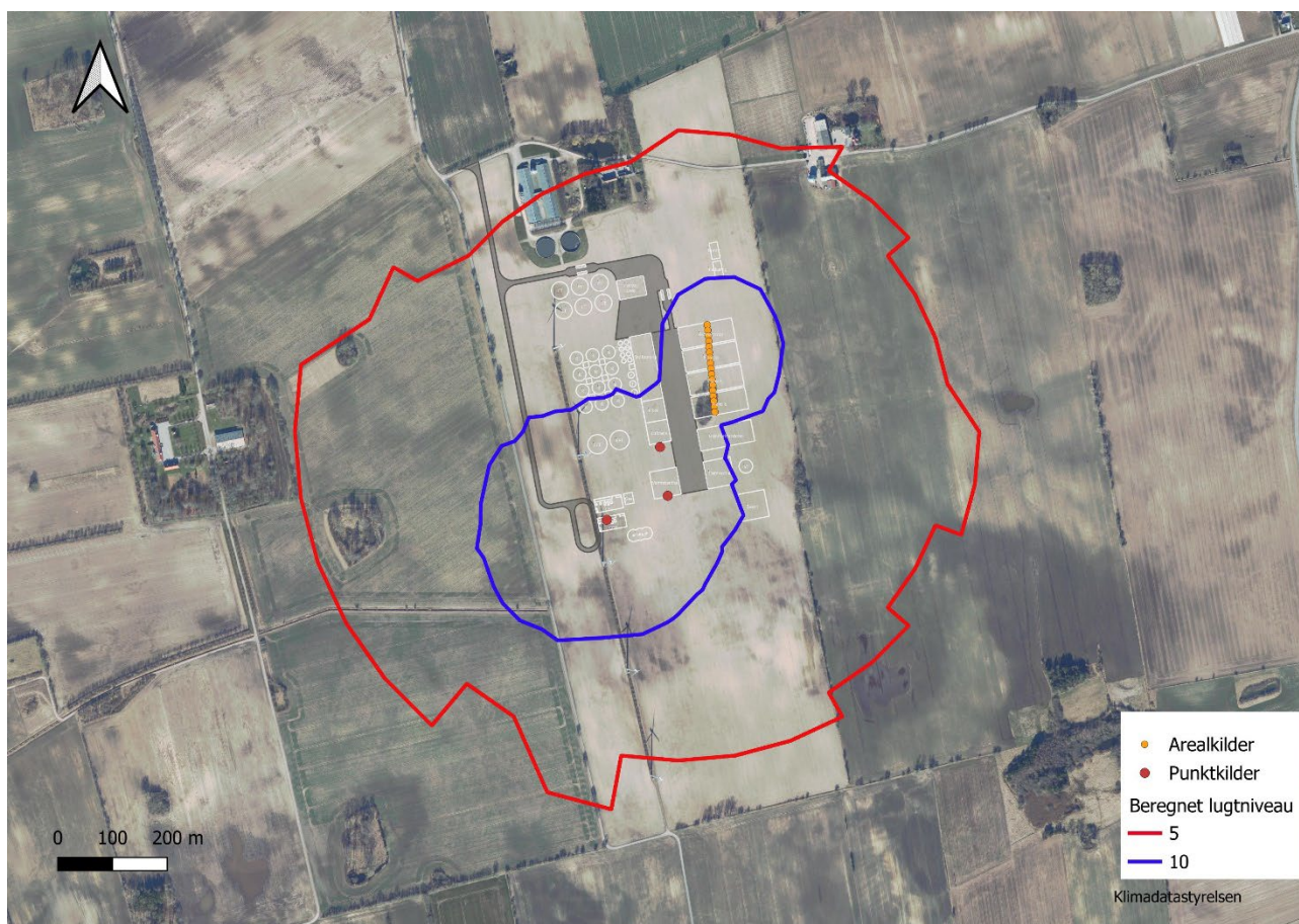
Figur 4-5 Lugtudbredelse fra biogasanlægget.
